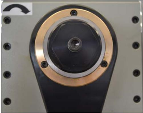
Verificare che il senso di rotazione corrisponda a quello indicato sulla pressa. Nel caso il motore non girasse nel senso previsto invertire le fasi.
