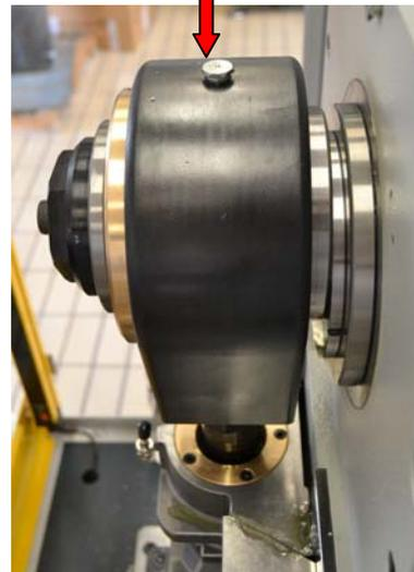
Ogni 300 ore di lavoro provvedere all'ingrassaggio tramite gli ingrassatori. Utilizzare la pompa per grasso data in dotazione. Il grasso da utilizzare è MARTINELLI ART. 5502 (cod. P0859)
