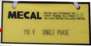
Targhetta tensione di alimentazione
